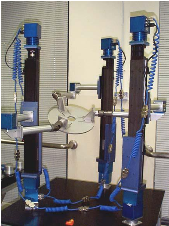
Robot paralel reconfigurabil de tip RPRS (stanga) si RRRS(dreapta) cu 6 GDL
